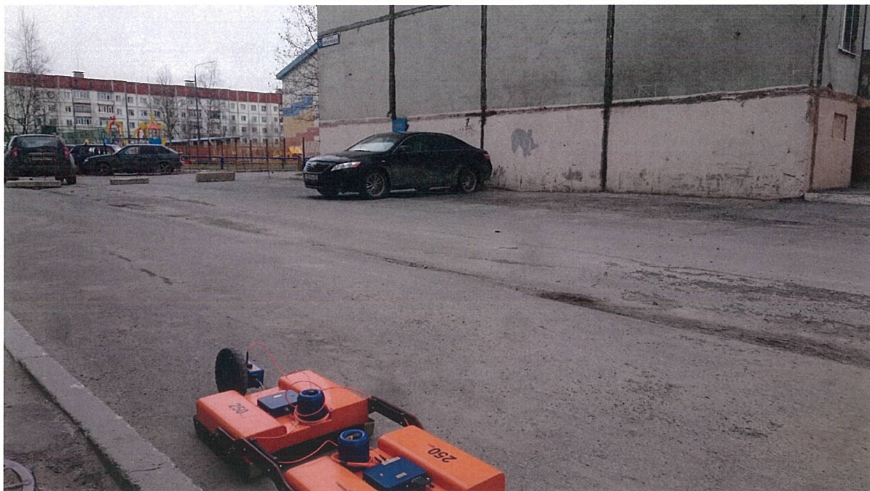
Рис. 1. Поперечное георадарное сканирование.
