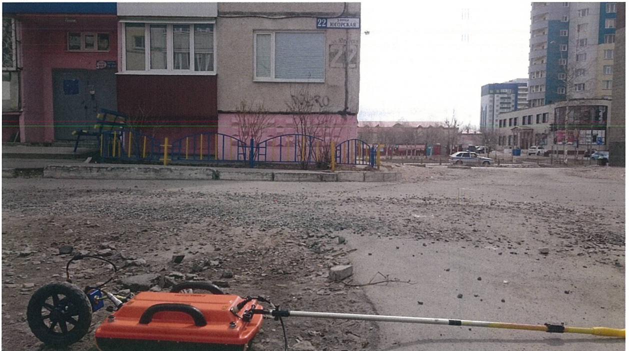
Рис. 1 – Фотография участка возле дома по ул. Югорская 22 с примером георадарного сканирования.
