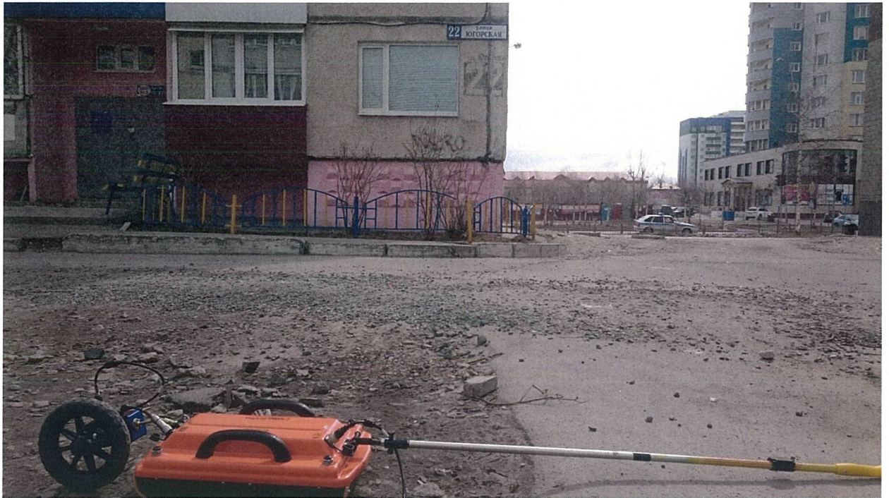
Рис. 3. Поперечное георадарное сканирование.
