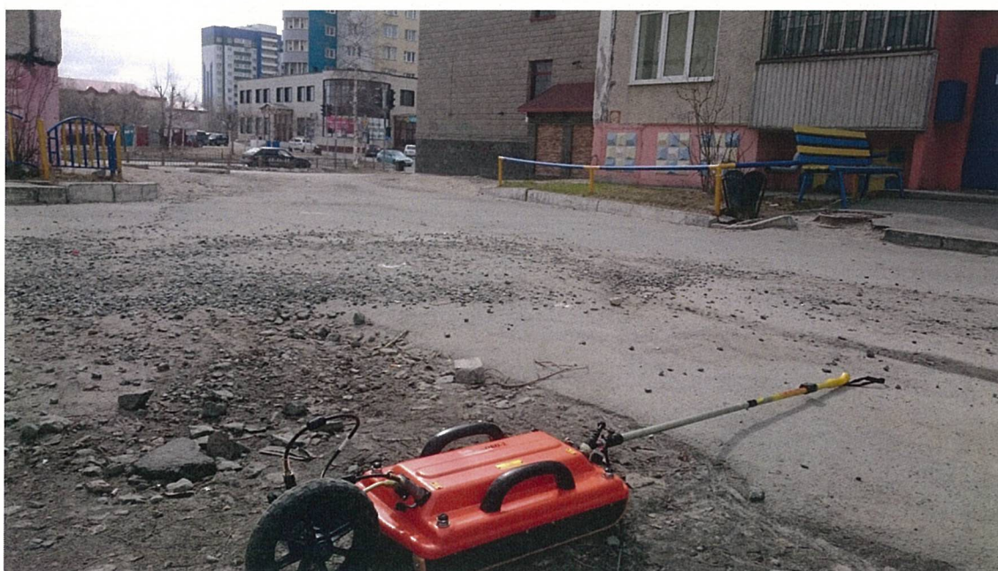
Рис.1 – Пример георадарного сканирования.
