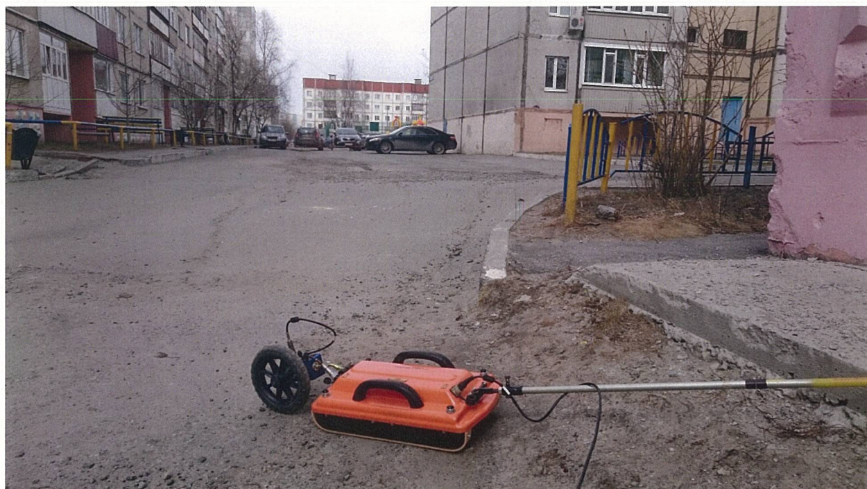
Рис. 2. Поперечное георадарное сканирование.
