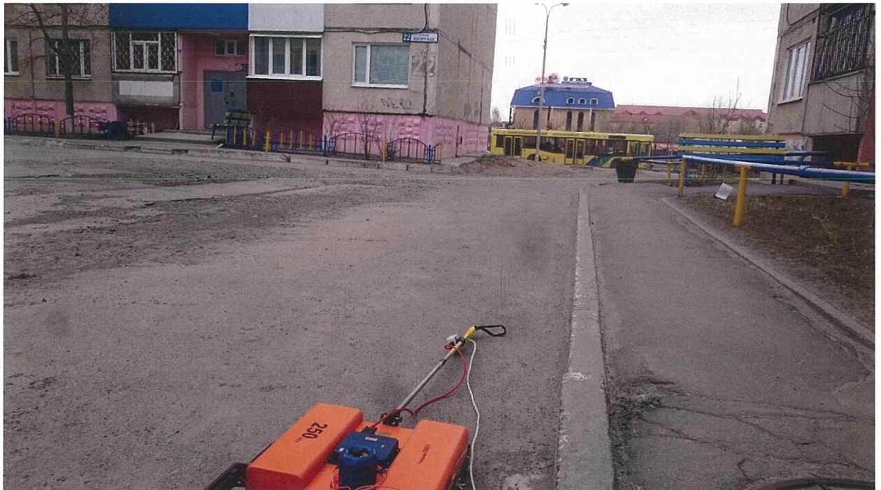
Рис.4. Поперечное георадарное сканирование.
